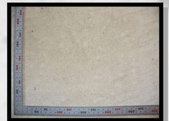
スーパークラックレスを使用したコンクリートの表面状況
