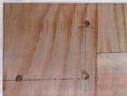
実験前の状態。5mmめり込みだとくぎ頭が見えにくい
