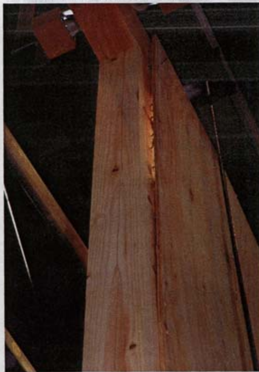
上の写真が「パンチングシア」を起こした様子。合板が裂け、くぎは合板からはずれて柱側に残った。めり込みなしと終局は大きく異なったが、性能的にはほぼ問題のない数値が出て、打ち増しの効果も発揮された
