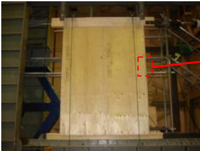
耐力壁の実物大モデル
